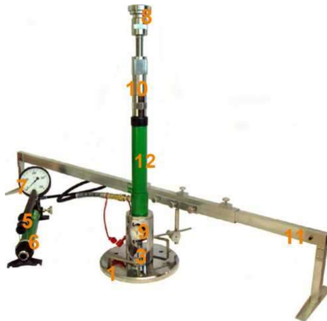
Rys. 1.2 Aparatura VSS z jednopunktowym pomiarem przemieszczenia płyty
